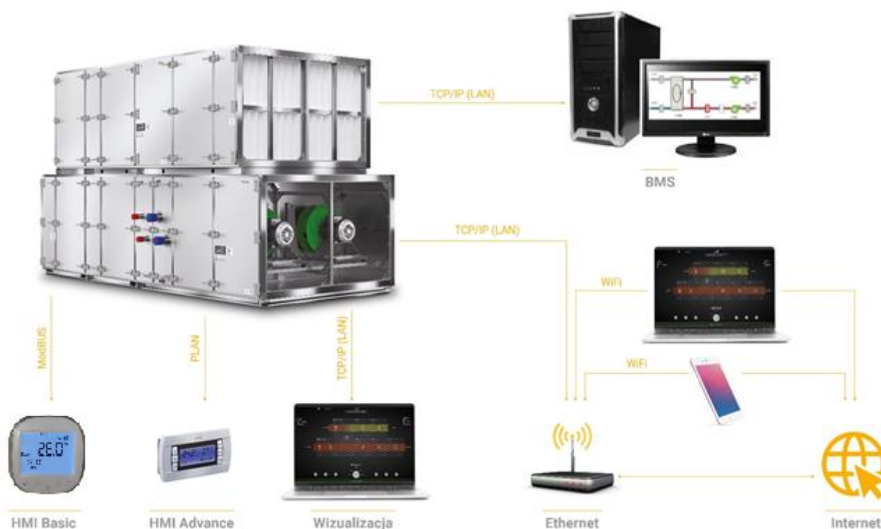
Rys. 13. Możliwości obsługowe sterownika centrali VENTUS.
