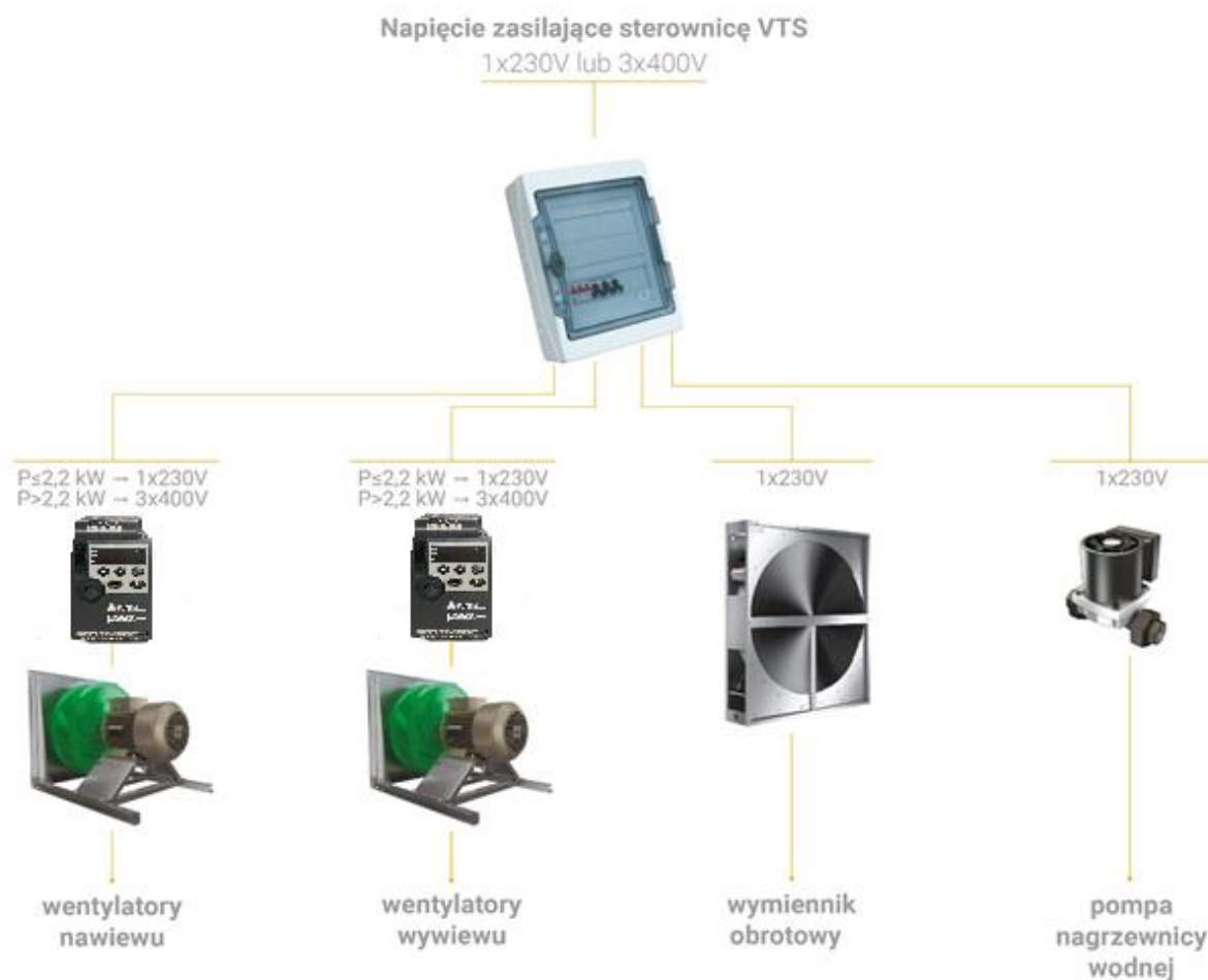
Rys. 1a Podzespoły zasilone ze sterownicy (centrala z silnikami AC)
